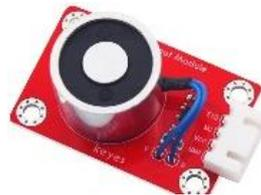
图 3.39 吸盘式电磁铁
