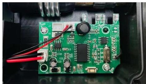
图 3.13 电机控制模块
